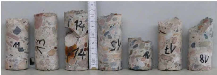
Bild A 2: Bohrkern 11, 13 – 14 bis 18 bei der Anlieferung (Durchmesser ca. 44 mm)
