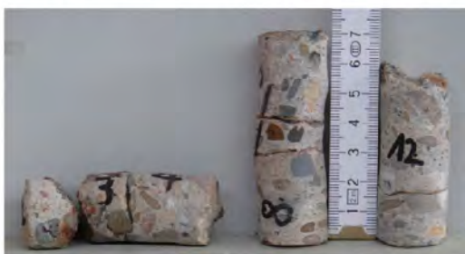
Bild A 3: Bohrkern 5, 8, 12 bei der Anlieferung (Durchmesser 23 mm)
