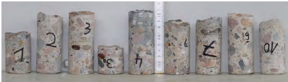
Bild A 1: Bohrkern Nr. 1 – 3, 3a, 4, 6, 7, 9, 10 bei der Anlieferung (Durchmesser ca. 44 mm)
