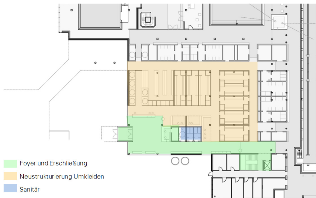
Abb. 6.1.5 Neustrukturierung Eingangsbereich / Umkleiden
