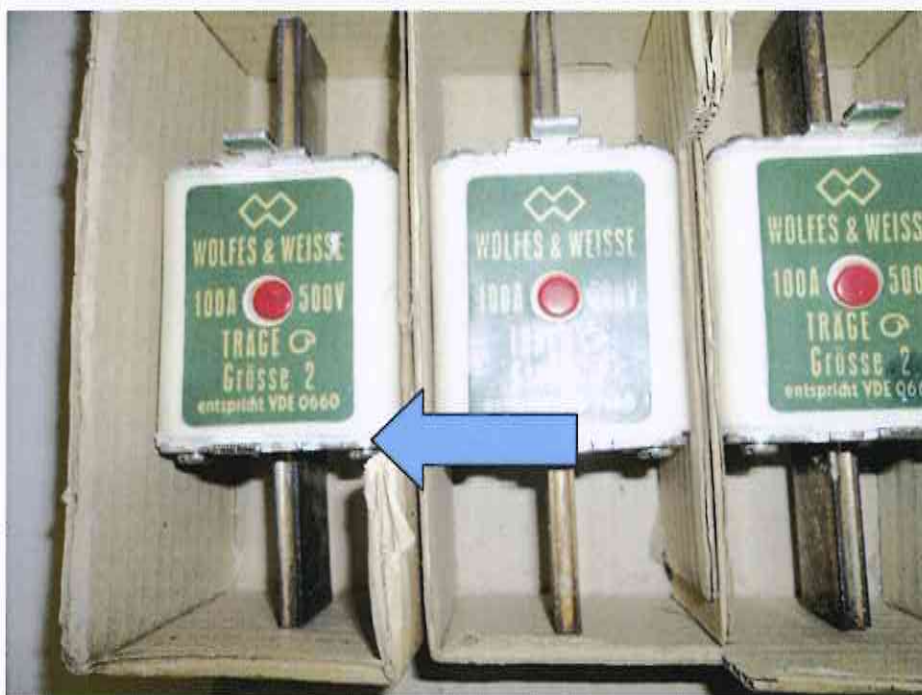
Bild 13: NH-Sicherungen mit asbesthaltiger Isolierung
